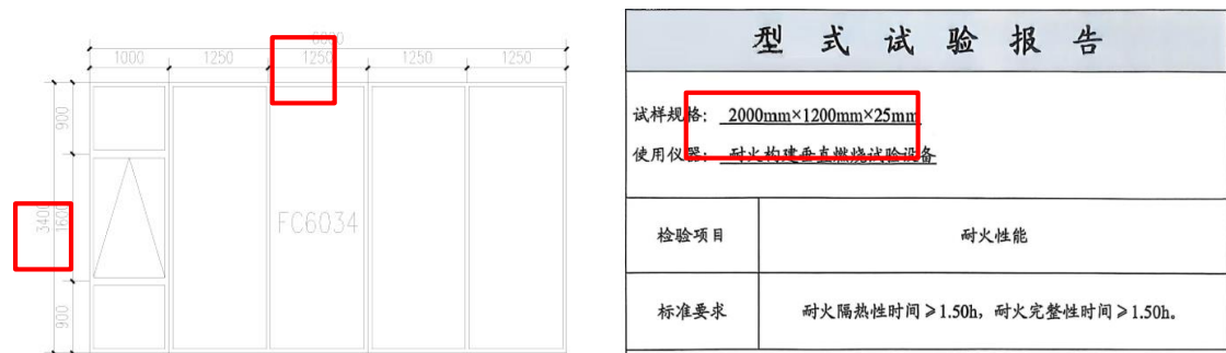
2.2-33 错误做法: 防火玻璃构件尺寸大于提供的检测报告中尺寸
