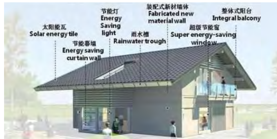
▲德国生态园建筑节能技术示意图
